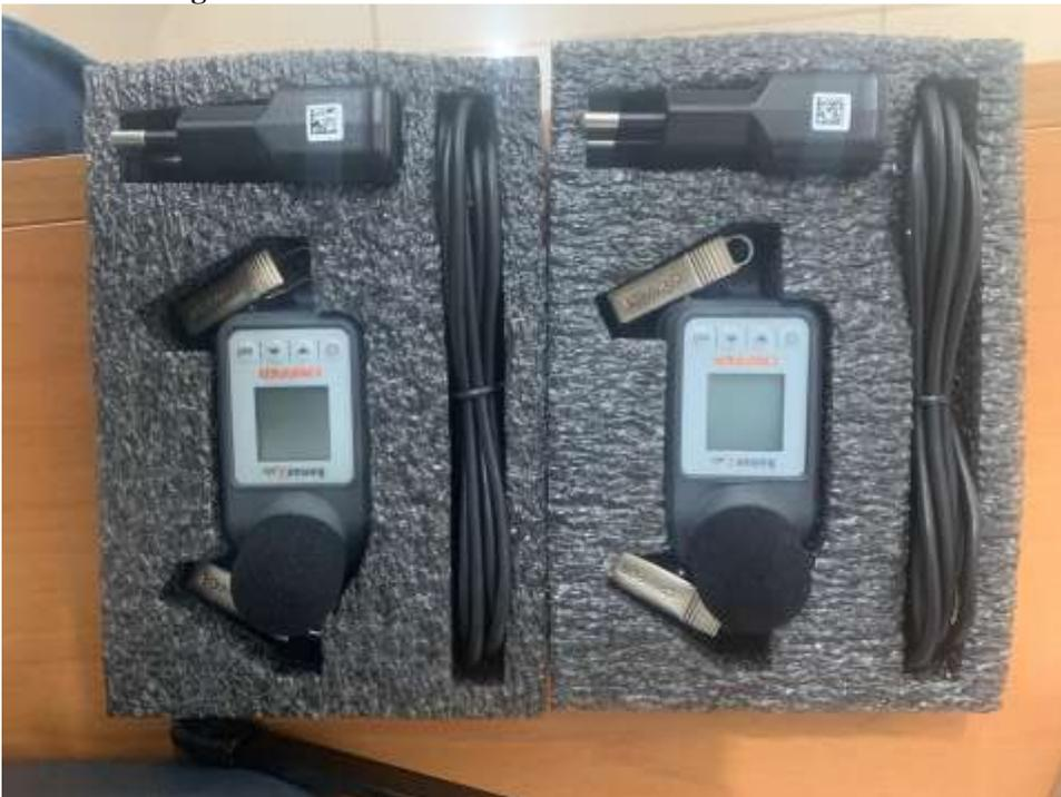
**Sensor de Vibração – Corpo Inteiro e Membros Inferiores/Superiores**
